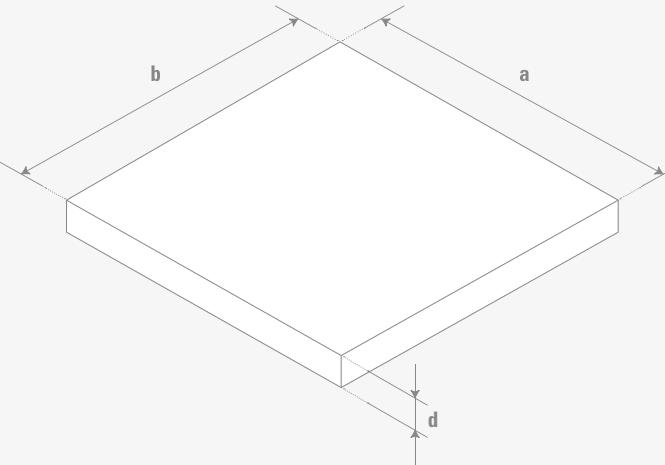
**Dimensão de Fabrico (W) = Dimensão da face visível (a e b) e espessura (d)**
