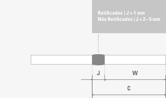
**Dimension de Fabrication (W) = Dimension de la face visible (a et b) et épaisseur (d)**
